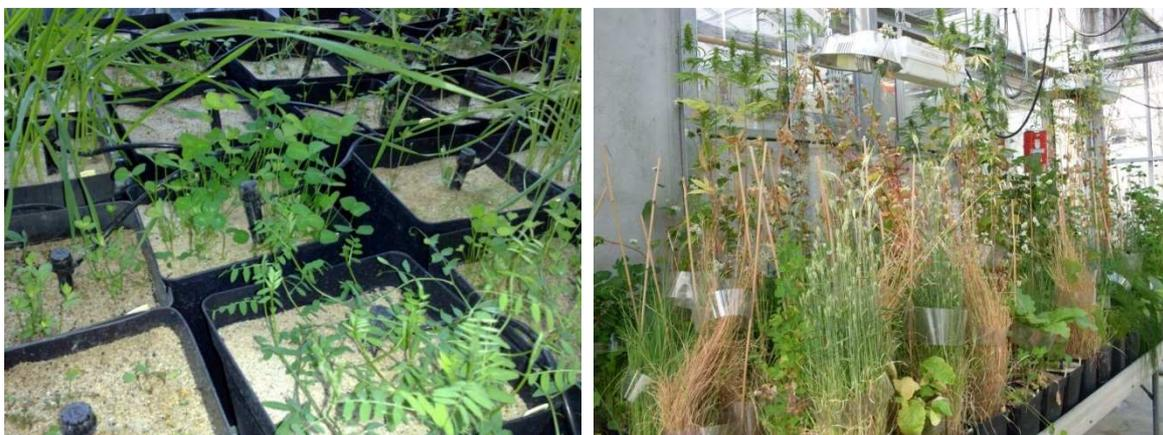
**Figure 1 : Dispositif des tests d'efficacité en conditions contrôlées : semis irrigué au goutte à goutte (à gauche) et lumière artificielle pour photopériode en 16h/8h (à droite).**
